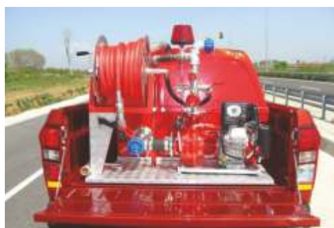
Σύστημα πυρόσβεσης οχημάτων
